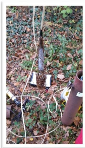
*Racines obstruant l'intérieur du piézomètre équipé d'une centrale (point RCS)*
