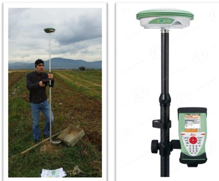
*Matériel de nivellement GPS par satellites*
